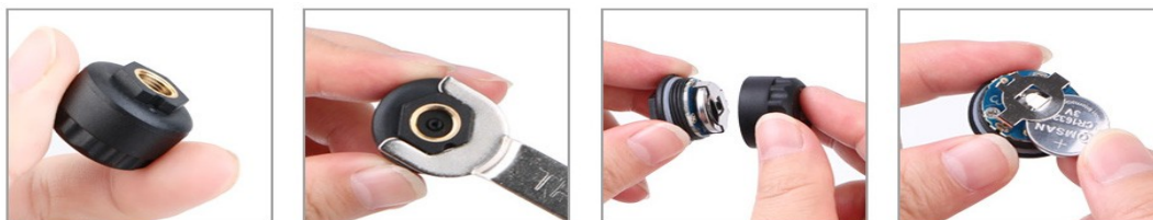
1. Senzor 2. Speciální malý klíč 3. Odšroubujte kryt 4. Vyměňte baterii
