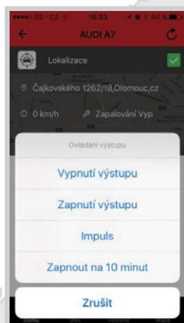
Výstup jednotky lze vypnout, zapnout, poslat krátký impuls nebo výstup zapnout na předem definovanou dobu.
